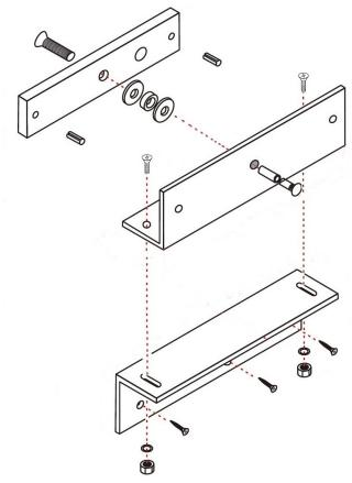
На монтажной схеме показано крепление пластины якоря электромагнитного замка к кронштейну. Обратите внимание, пластина якоря за счет резинового кольца должна иметь люфт около 3-5 мм относительно уголка кронштейна для обеспечения плотного прилегания к замку.
