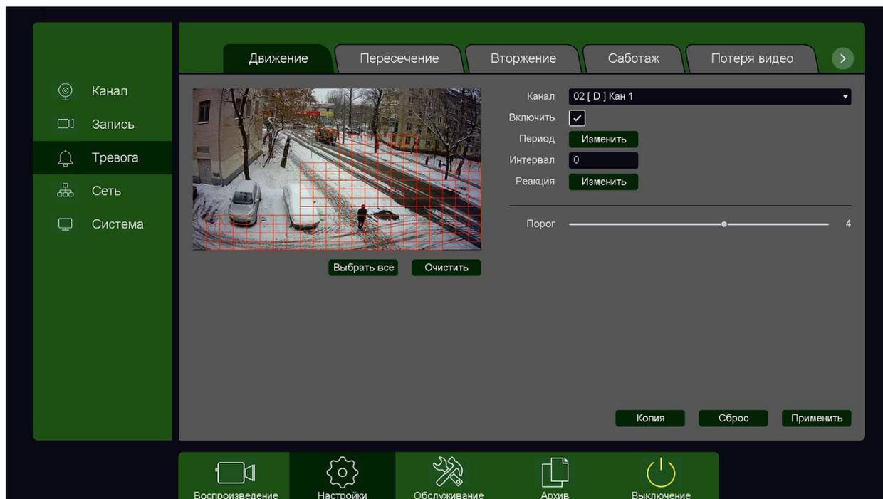
Выберите **Канал** Канал 02 [ D ] Кан 1 регистратора, к которому подключена IP камера.
