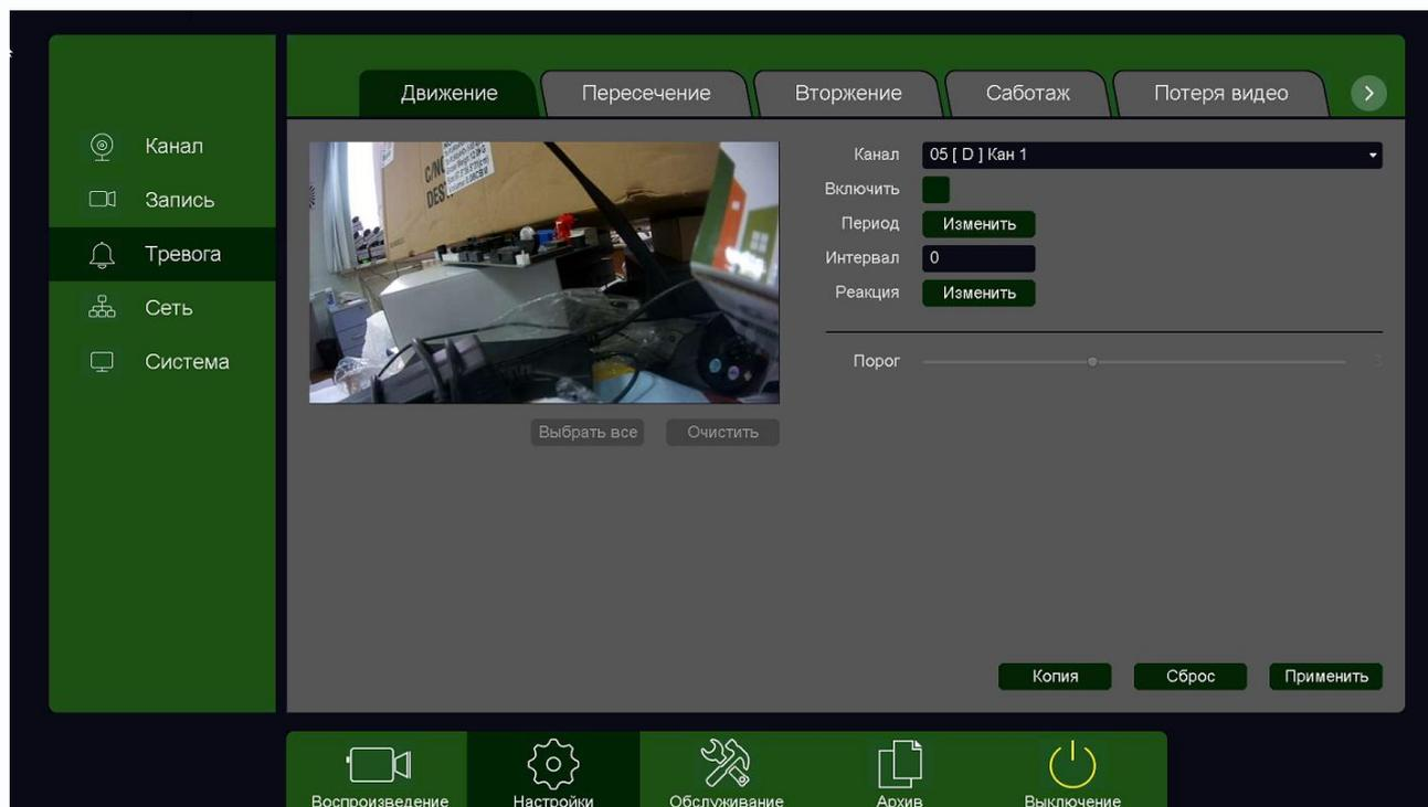
Выберите **Канал** Канал 05 [ D ] Кан 1 регистратора, к которому подключена IP камера.
