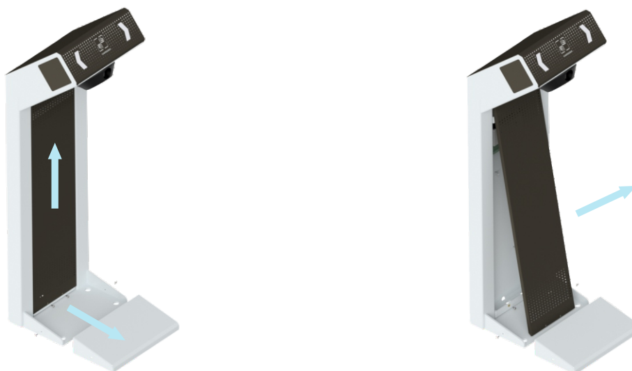
Рисунок 15 – Разборка кожухов турникета
