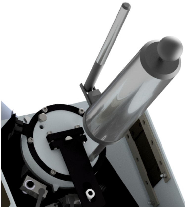
Рисунок 27 – Доливка демпферной жидкости
