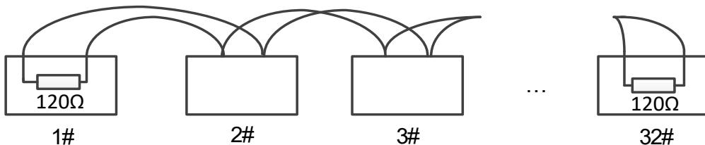
Рисунок A.5.1 Подключение RS-485 (1)
