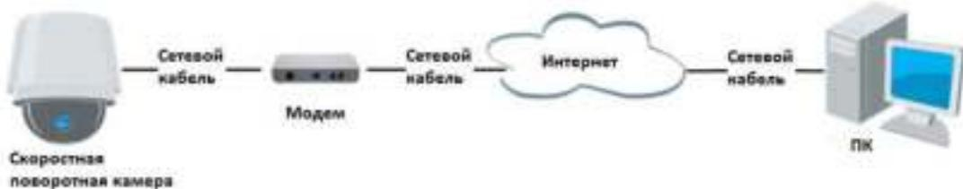
Рисунок 2-12 Доступ к камере с динамическим IP-адресом
