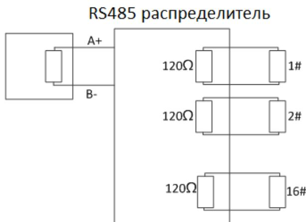
Рисунок A.5.4 RS-485 распределитель
