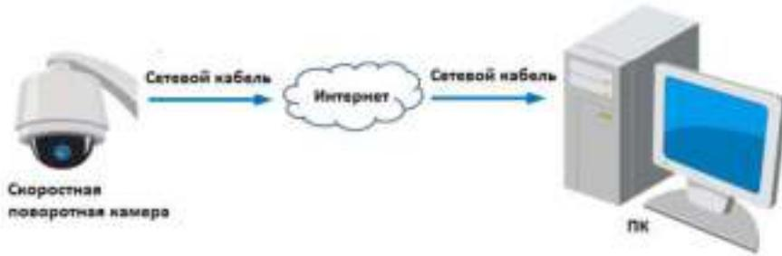
Рисунок 2-11 Доступ напрямую к камере со статическим IP-адресом
