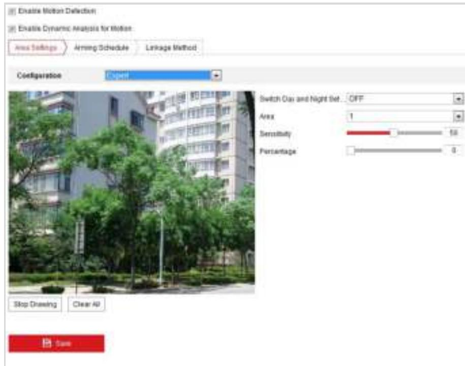
Рисунок 5-12 Настройки обнаружения движения - Экспертный режим
