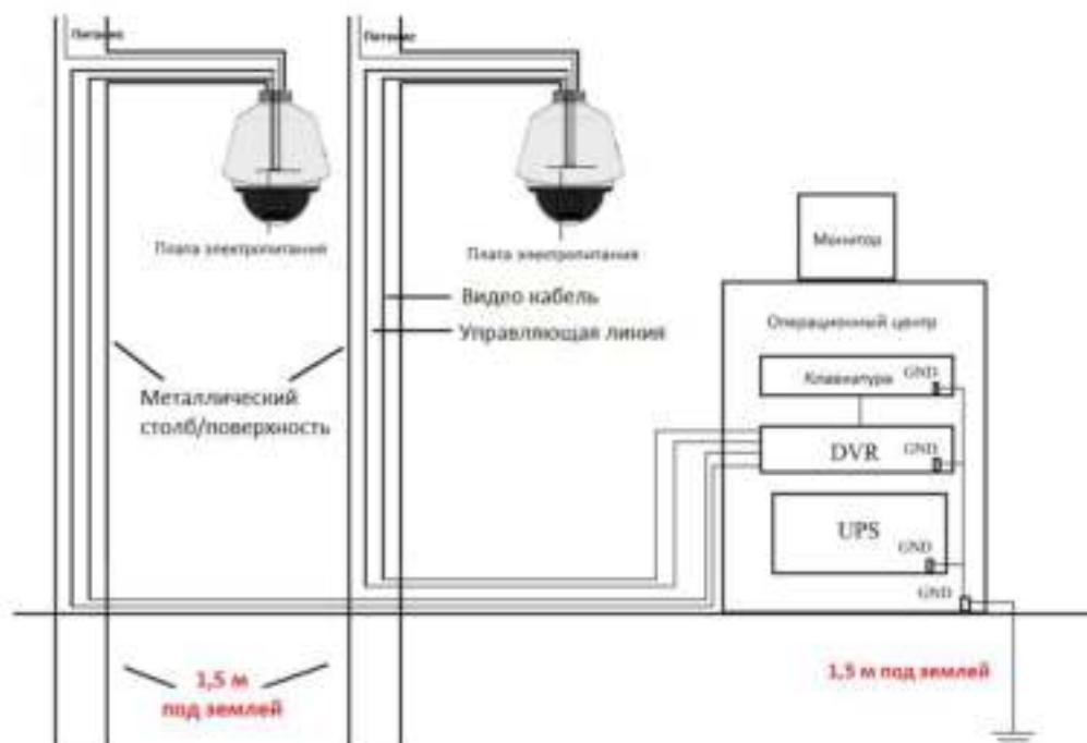
Рисунок А.2.4 Заземление при установке на металлический столб
