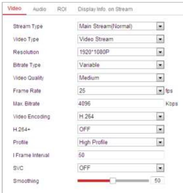
Рисунок 6-21 Настройка параметров видео
