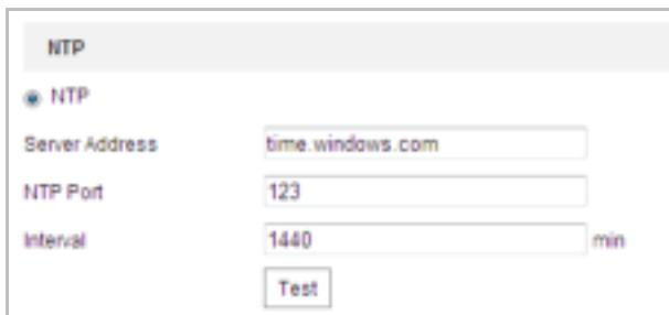
Рисунок 6-40 Синхронизация времени с NTP сервером
