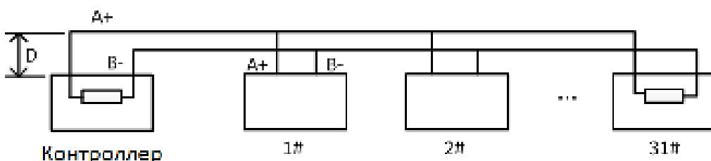
Рисунок A.5.2 Подключение RS-485 (2)
