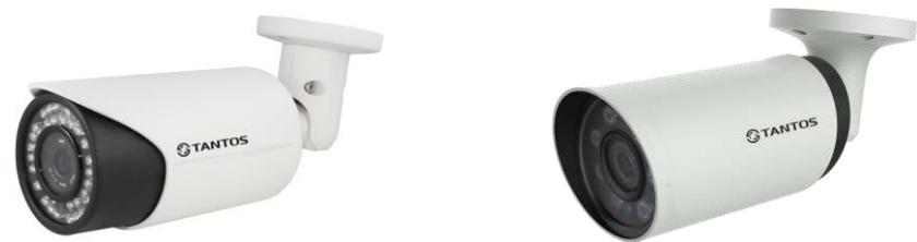
На шлейфе видеокамеры расположены разъемы с розеткой RJ45 и разъем питания 12 В. IP адрес по умолчанию – 192.168.1.10
