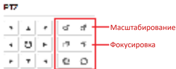
Рисунок 2-12 Настройка масштабирования и фокусировки через веб-браузер
