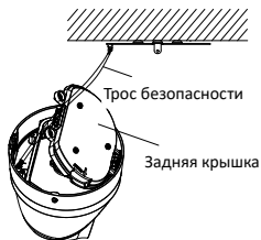
Рисунок 2-7 Крепление камеры к монтажной платформе
