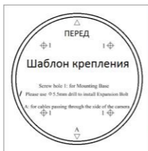
Рисунок 2-7 Шаблон крепления распределительной коробки
