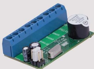
Контроллер JSB-CL002 предназначен для использования совместно с электромагнитными/ электромеханическими замками в качестве автономного контроллера для ограничения доступа в подъезды жилых домов, в помещения административных учреждений, промышленных предприятий.
