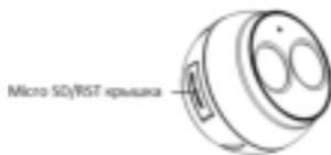
Рисунок 2-16 Крышка Micro SD/RST
