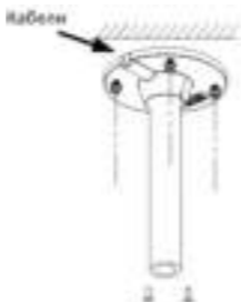
Рисунок 2-33 Установка подвесного кронштейна
