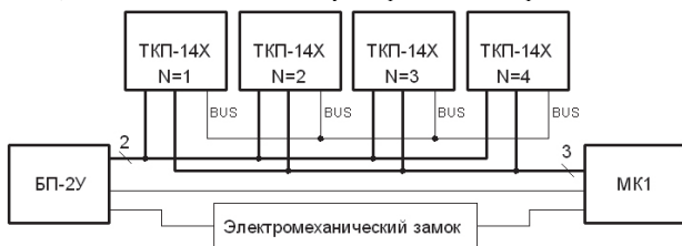
Рис.2. Схема подключения четырех трубок к одной вызывной панели.
