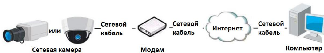
Рисунок 2-12 Доступ к видеокamере с динамическим IP-адресом
