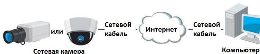
Рисунок 2-11 Доступ напрямую к видеокамере со статическим IP-адресом
