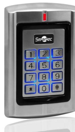
Автономный вандалозащищенный контроллер ST-SC140EK со встроенным считывателем проксимити карт EM и клавиатурой предназначен для построения автономной системы контроля доступа с управлением одной дверью. Поддерживаются режимы идентификации: карта или код, карта плюс код, только карта. Наличие клавиатуры обеспечивает возможность удаления отдельных пользователей и карт, например, при их утере, т.е. без наличия самих карт.
