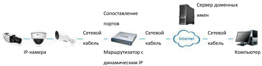
Рисунок 2-2. Подключение сетевой камеры через маршрутизатор, используя динамический IP-адрес.
