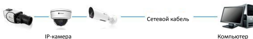
Рисунок 2-1-1. Непосредственное подключение камеры к ПК.
