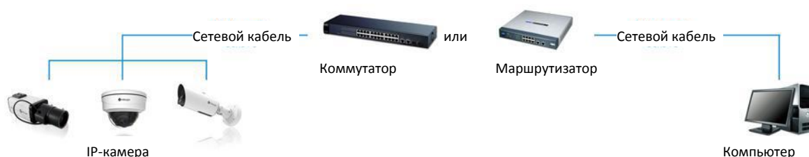
Рисунок 2-1-2 Подключение через коммутатор или маршрутизатор
